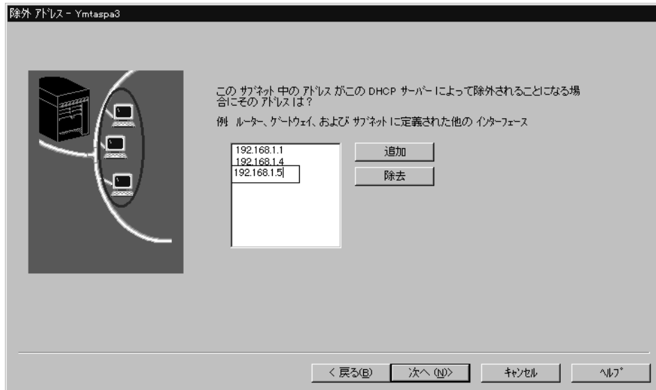
図22. 除外アドレス. 8ページの図5で、サブネット 192.168.1.0 は、ルーター、サーバー、およびドメイン・ネーム・サーバーを除外します。
