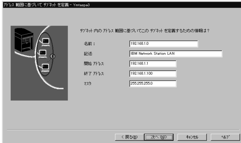
図 21. アドレス範囲に基づいてサブネットを定義. 8ページの図5 の構成サンプル。
