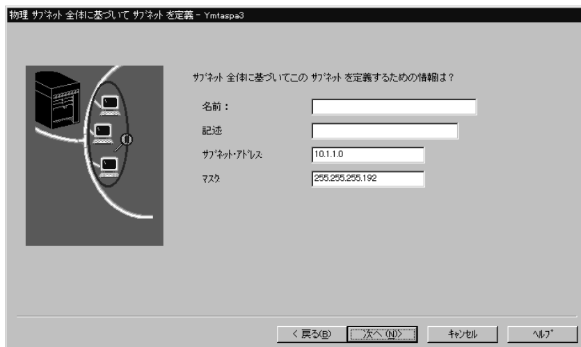
図 20. サブネット全体の定義. NS3 および NS4 が平衡型ネットワークステーションである場合の 8 ページの図 5 の構成サンプル
