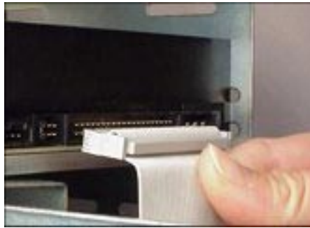
図 65. SCSI および IDE ハードディスク・インターフェース
